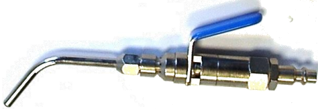
Soufflette progressive de sécurité avec écran d'air. Entrée coupleur rapide mâle. Corps en laiton nickelé.
