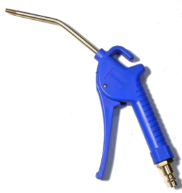
Soufflette progressive (320 l/mn à 6 bars) Entrée coupleur rapide mâle.
